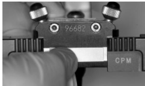
Abb. 4.10-7: Aufkleben des Selbstklebeetikettes auf der Rückseite des Artex-CPM in der dafür vorgesehenen Vertiefung
