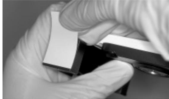
Abb. 4.10-5: Aufkleben der Selbstklebeetiketten auf die sagittalen Flächen der roten Registrierboxen des CPM vor der Vermessung der Registrate
